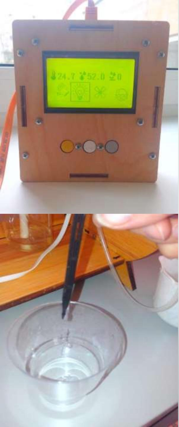
Пульт управления с ЖК дисплеем. На нем отображается температура воздуха в теплице, влажность воздуха, влажность грунта в горшке, освещение, полив.
