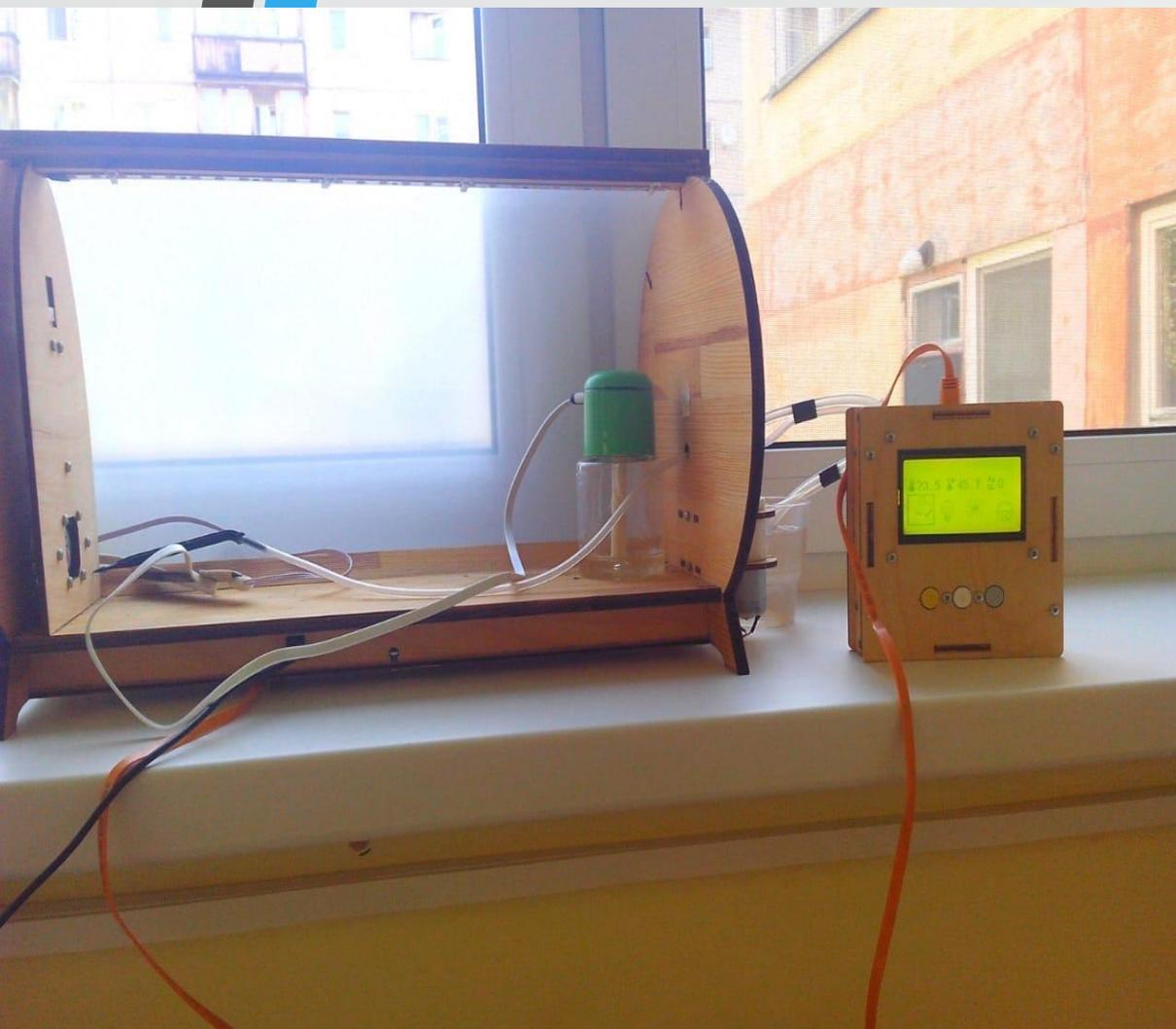
Изделие представляет собой настольную модель теплицы-оранжереи, оборудованную независимыми модулями освещения, полива, вентиляции, увлажнения воздуха. Для удобства обслуживания теплица оснащена прозрачной откидной дверцей.
