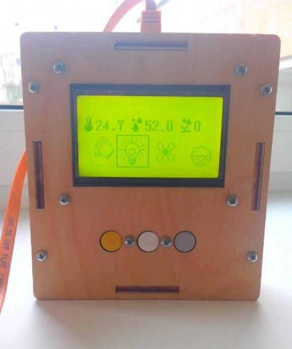
Пульт управления с ЖК дисплеем. На нем отображается температура воздуха в теплице, влажность воздуха, влажность грунта в горшке, освещение, полив.
